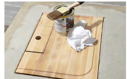
**30.** Jetzt alle Teile nochmals mit lebensmitteltauglichem Hartwachsöl oberflächenbehandeln. Die Lappen ausgebreitet trocknen lassen. Selbstentzündungsgefahr!
