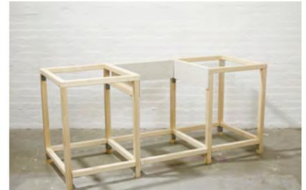
**15.** Jetzt ist das Untergestell so weit fertig, dass der Grill testweise eingehängt werden kann.
