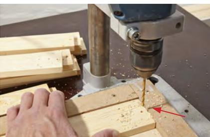
**19.** Um die vielen Leisten vorzubohren, lohnt es sich, eine Unterlage mit Anschlag zu bauen: In den Winkel lassen sich die Leisten einlegen, eine Markierung am Rand zeigt die Position des Bohrlochs.
