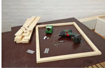
**23.** Am Korpus werden zwei Türen montiert: Links an der Front, rechts an der Seite. Türrahmen zusammenschrauben.
