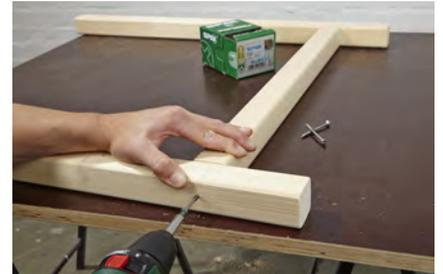
6. Die Teile per Verschraubung (4x60) verbinden. Vorbohren nicht vergessen.
