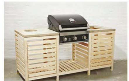
**27.** Den Grill auflegen und anschrauben. Wer optional ein Schneidebrett mit Müllfänger einbauen möchte, sollte jetzt die Konstruktion dafür bauen (siehe Step 28). Dann die Arbeitsplatte auflegen. Die Betonplatte hält durch ihr Eigengewicht. Eine Holzplatte mit Winkeln fixieren.
