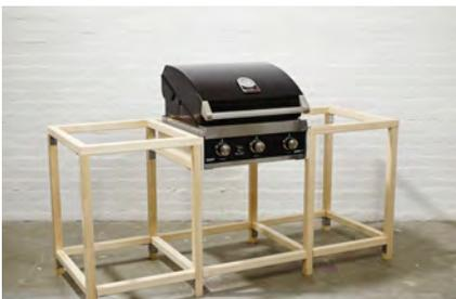
**16.** Dem von uns verwendeten Einbaugrill liegen Winkel bei, die sich seitlich anschrauben lassen (auf Bild Schritt 11. zu sehen). So lässt sich der Grill einfach auflegen und mit wenigen Schrauben fixieren.
