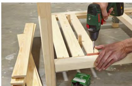
**20.** Die Leisten testweise einlegen, Abstände ermitteln und anschrauben (Schrauben 3,5x30). Auf's Lückenmaß zugeschnittene Abstandshölzer erleichtern die Arbeit.
